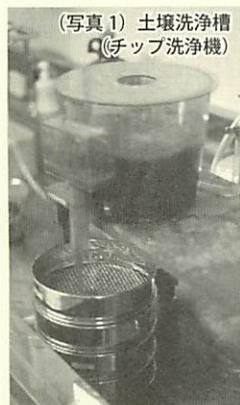
(写真1) 土壤洗浄槽
